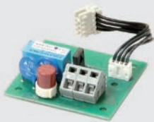
Contact fără potențial, compatibilă cu toate tipurile de dispozitive de avertizare și comandă Art. # 80 072
